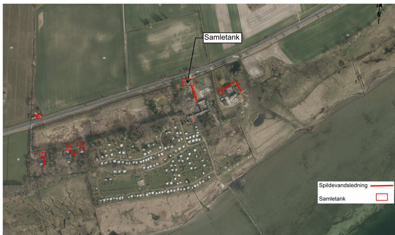
Figur 5 - Skitsering af løsning 3. Placering af samletanke er ikke nøjagtig.
